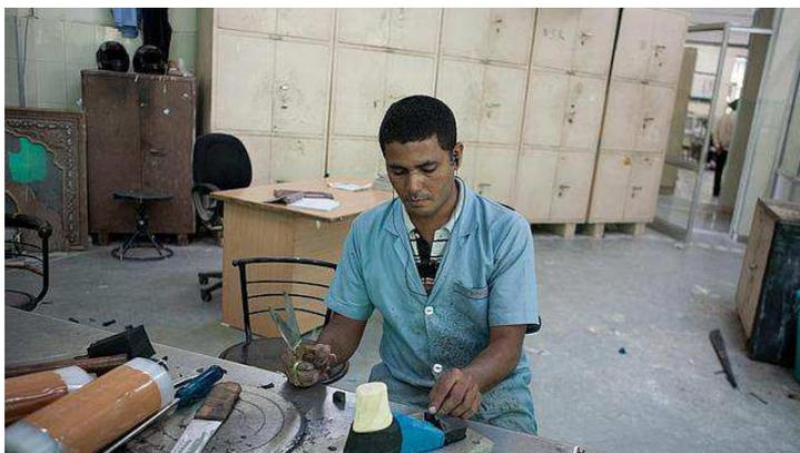
En un taller cercano varios hombres dan forma al caucho. El pie consta de tres partes diferentes de goma y una de madera que hace las veces de talón. Todo se recubre con una capa de goma color carne y se introduce en un molde en el horno a 250 grados. Después se unirá a una pierna artificial de PVC hecha a medida del paciente. **El coste es de 23 euros, lejos de los miles de euros que cuesta una prótesis estadounidense o europea**. Dura entre tres y cinco años.
